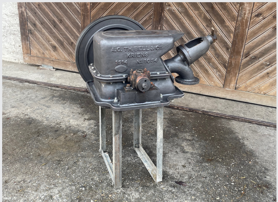
Erinnerungen an die erste Rohrer Stromversorgung: die Bell-Turbine aus dem Jahre 1914
