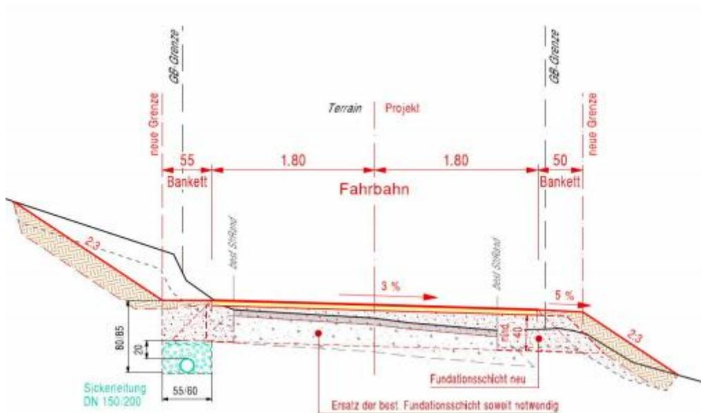
Die bestehende Sickerleitung wird bergseitig ersetzt mit einer neuen Leitung DN 150 im Bereich Schleipfi und DN 200 entlang des Rüttimattwegs.
